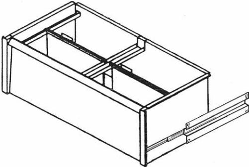
Stabile Stahlblechkonstruktion, sendzimir-verzinkt. Geräuschlose Auszüge. Ausziehbar bis 100% der Schubladentiefe. Optional abschliessbar.
