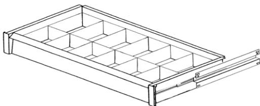
Pro Schublade sind mindestens 2 Stk. Längstrennwände, sowie 3 Stk. Quertrennwände nötig.
