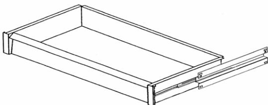
Stabile Stahlblechkonstruktion, sendzimir-verzinkt. Geräuschlose Auszüge. Ausziehbar bis 100% der Schubladentiefe. Optional abschliessbar.
