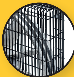
Doppelter Keilriemenantrieb für grosse Laufruhe
